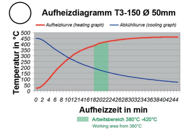
Nach ca. 18 min erreicht der Stempel die Arbeitstemperatur. **Heizen Sie den Stempel nie länger als 30 min vor!** Die Aufheizzeit kann abhängig von der Umgebungstemperatur abweichen.
