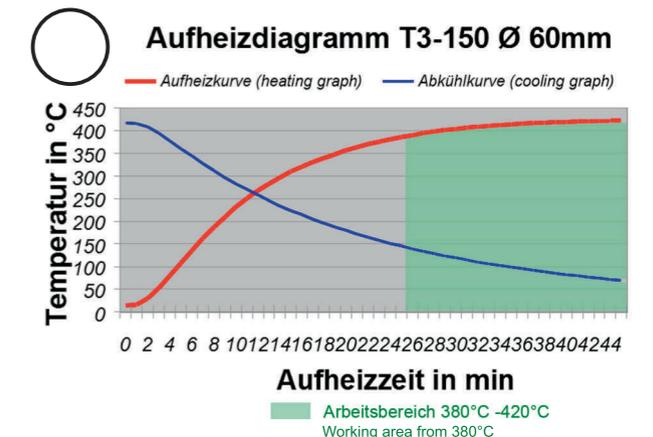
Nach ca. 25 min erreicht der Stempel die Arbeitstemperatur. **Heizen Sie den Stempel nie länger als 30 min vor!** Die Aufheizzeit kann abhängig von der Umgebungstemperatur abweichen.
