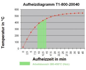
Nach ca. 12-15 min erreicht der Stempel die Arbeitstemperatur. Heizen Sie den Stempel nie länger als 20 min vor! Die Aufheizzeit kann abhängig von der Umgebungstemperatur abweichen.
